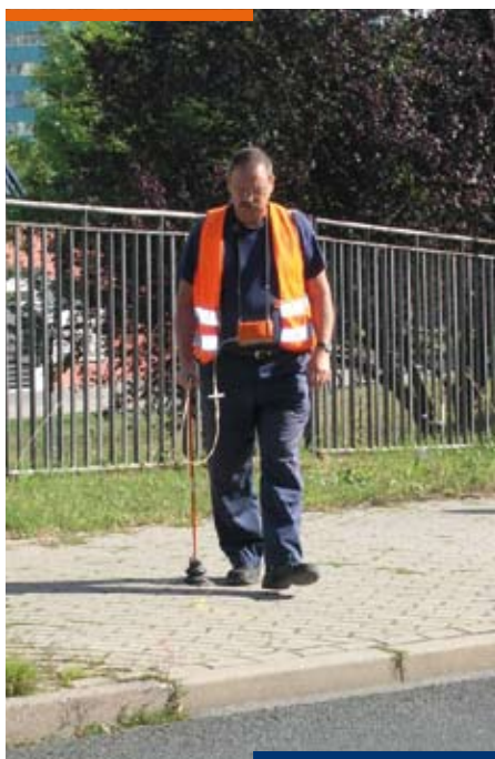
Möglichen Schäden an Gasleitungen auf der Spur: Uwe Schnelle mit seinem Gasspürgerät.
