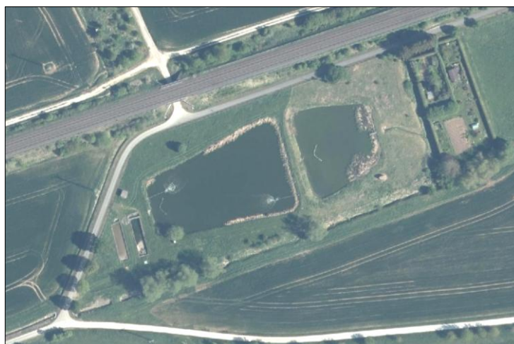
Abbildung 6: Draufsicht auf die Teichkläranlage Großschwabhausen
